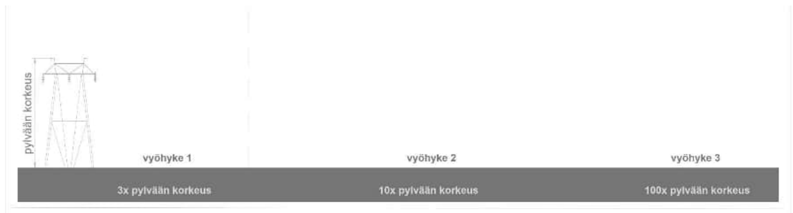
Kuva 133. Etäisyysvyöhykkeet sähkönsiirron vaikutusten arvioinnissa. (A-Insinöörit Suunnittelu Oy).
